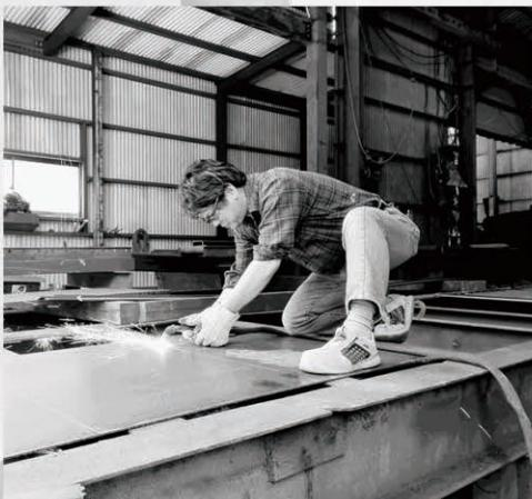
伊藤鉄工所で鉄板を溶断中の筆者。
