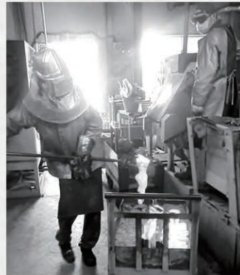
猫の鑄型にステンレス湯を鑄込んだ直後の風景。鑄型まで赤くなるが壊れない。
