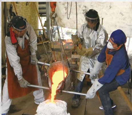
脱蠟した鑄型を半分土中に埋め、青銅を1250℃以上に熱して鑄込む。
