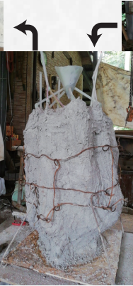
湯口をつけて耐火石膏で覆ってゆく。
